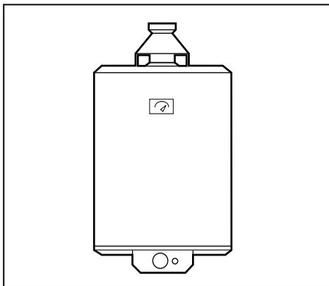
Для нормальной работы газового аппарата необходимо обеспечить правильную установку вытяжного колпака, как указано на рисунке. Категорически запрещается применение других способов установки, например таких, как указано на нижних рисунках.
