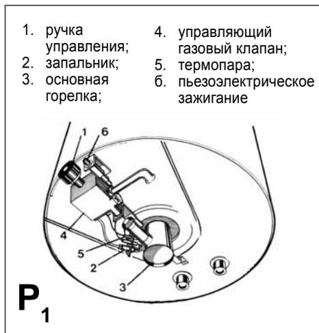
7.2. Утопить и не отпускать приблизительно 20 сек ручку (1), зажечь запальник (2) от какого-либо пламени или при помощи кнопки пьезоэлектрического зажигания. Если после отпущения ручки пламя запальника гаснет, то следует повторить указанную операцию в течение более длительного времени, необходимого для устойчивого горения запальника (2). Увеличение времени зажигания может быть связано с выходом воздуха из газового трубопровода.
