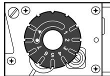
5.1. Водонагреватели обычно предназначены для работы на природном газе (метан G20) с тепловой производительностью 8100 ккал/м<sup>3</sup> и не требуют дополнительной регулировки. **Настройка на другой тип газа должна осуществляться квалифицированным техником.**
