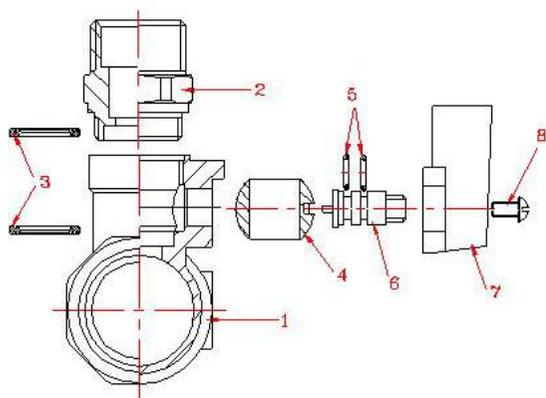
Внутри корпуса между прокладок из PTFE (тефлона) 3 расположен шаровой латунный затвор 4. Затвор приводится в движение латунным штоком 6. Уплотнение штока обеспечивается двумя сальниковыми кольцами из EPDM 5. Ручка 7 крепится к штоку с
