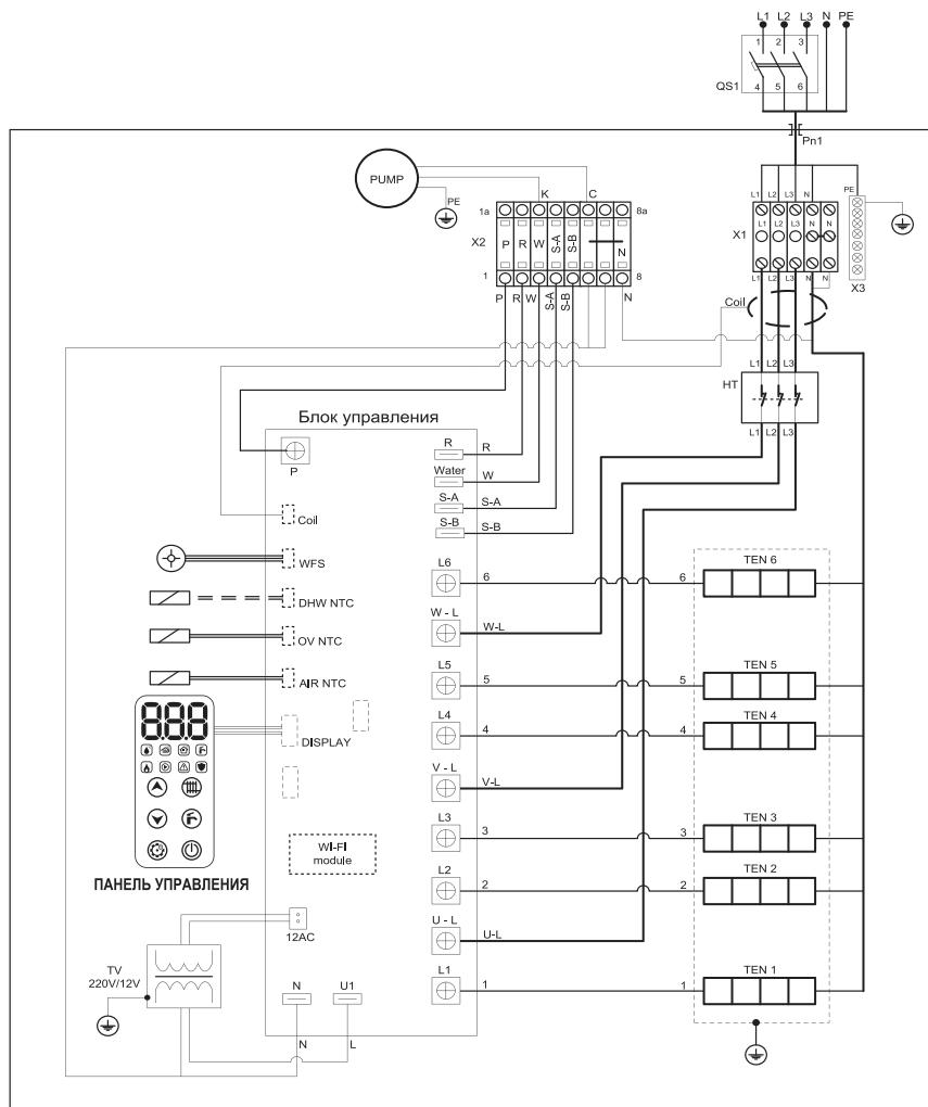
**Рисунок 13 - Схема подключения котла PROPLUS 4,5-18 кВт
