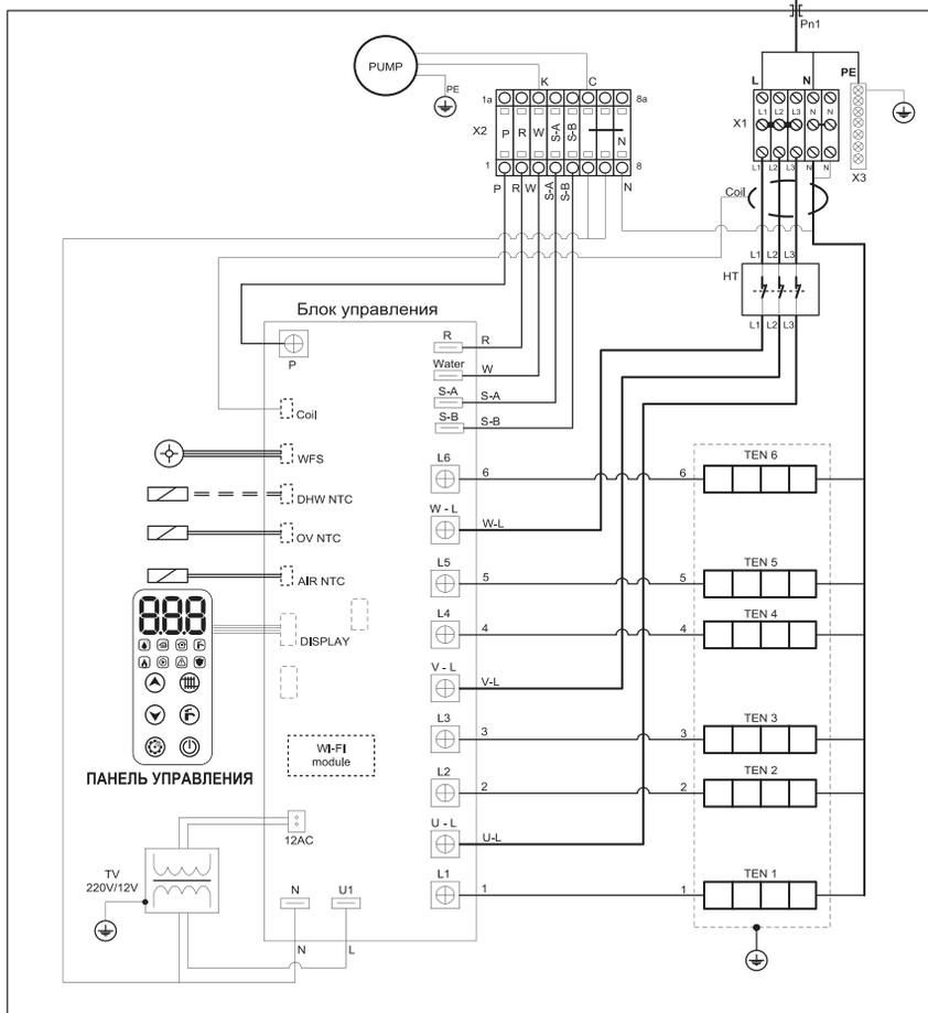
**Рисунок 14 -** Схема подключения котлов PROPLUS 4,5 кВт, 6 кВт и 7,5 кВт к однофазной сети 220В (50Гц)
