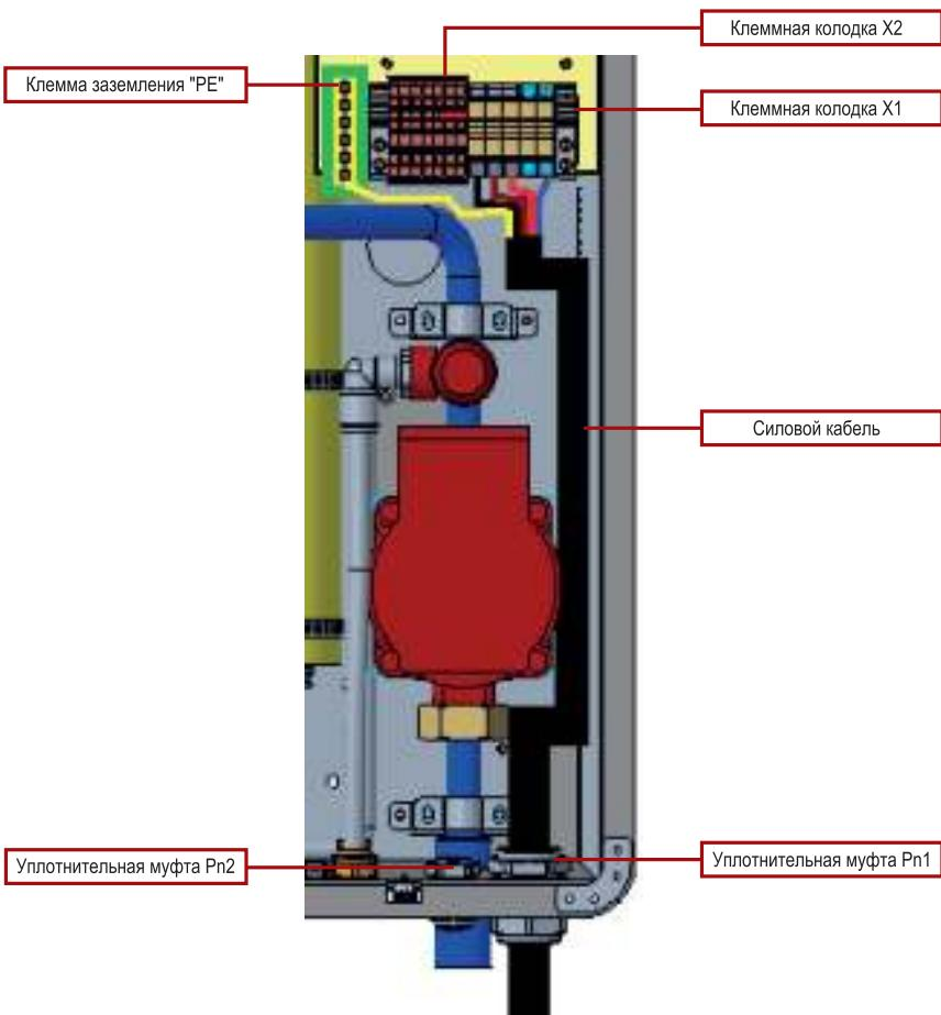
**Рисунок 9** - Прокладка силового питающего кабеля внутри котла
