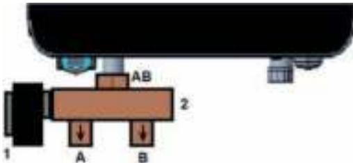
1 – Электропривод трехходового клапана;
