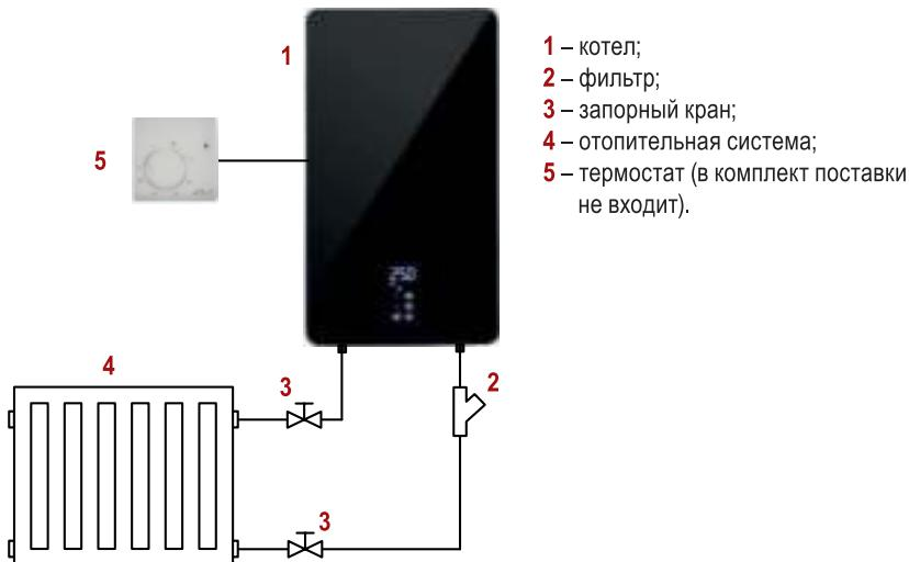
Рисунок 19 - Подключение термостата (в комплект поставки не входит)
